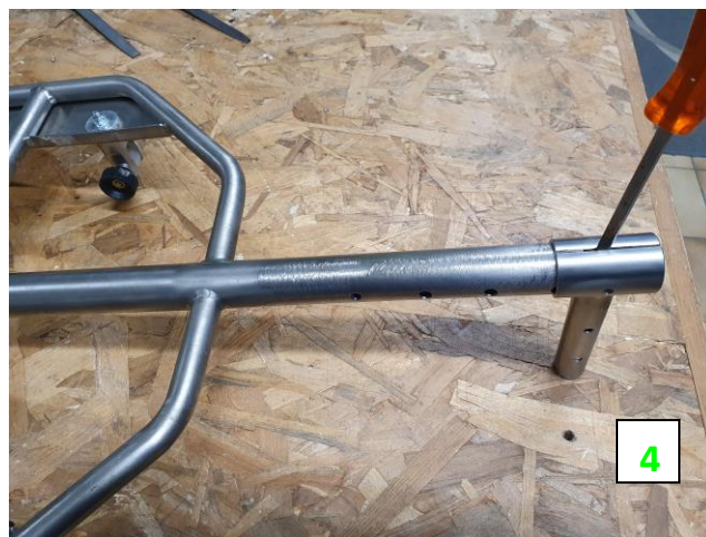
Ecartement du support pour emboîtement sur le tube central
